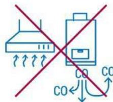
Не включайте вытяжку, когда работают газовый котёл или водонагреватель – угарный газ может попасть в помещение.
